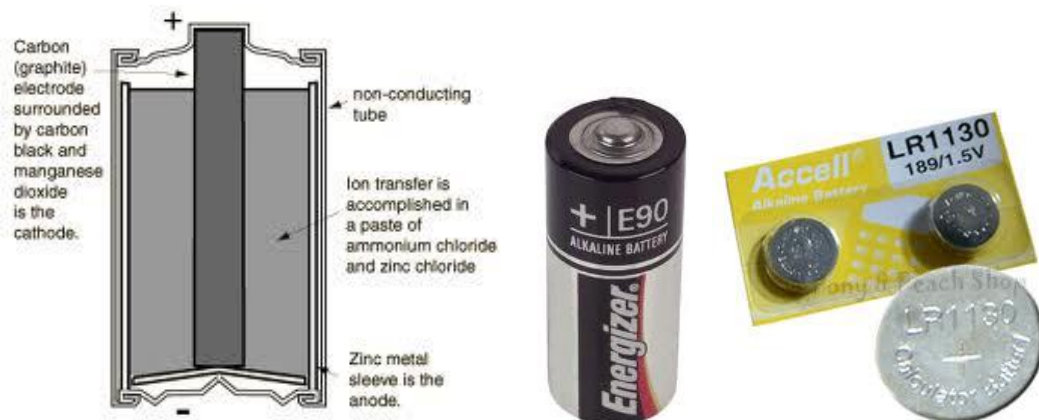
รูปที่ 1-3 โครงสร้างและลักษณะของเซลล์แบบอัลคาไลน์
